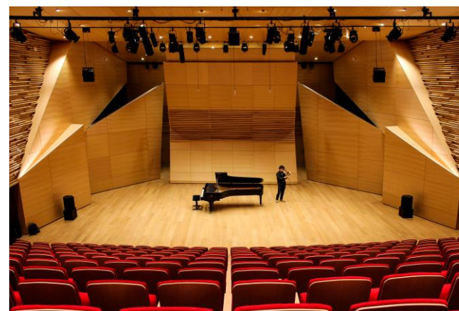
Optimisation forme et réglage des inclinaisons des parois ou réflecteurs latéraux
