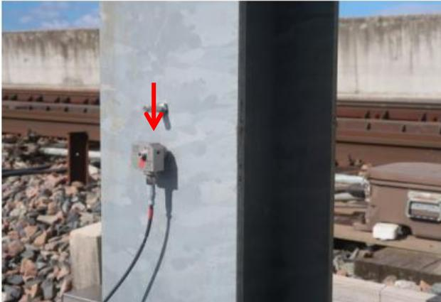
Capteur de vibrations sur un caténaire
