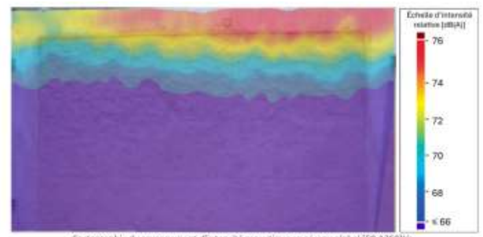
Cartographie du rayonnement d'intensité acoustique en niveau global [50-1250]Hz dans la configuration sans mortier
