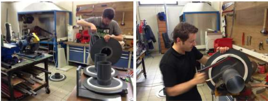
Recoupage des cols des résonateurs pour ajustement des fréquences de résonance :
