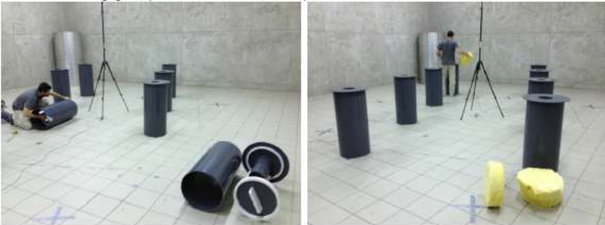
Réglage des profondeurs de cavité, et mise en place de la laine minérale en fond de de cavité.
